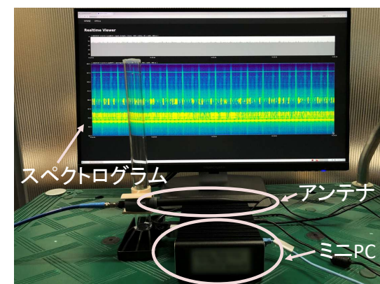
ミニPCから放射される電波雑音の観測の様子
