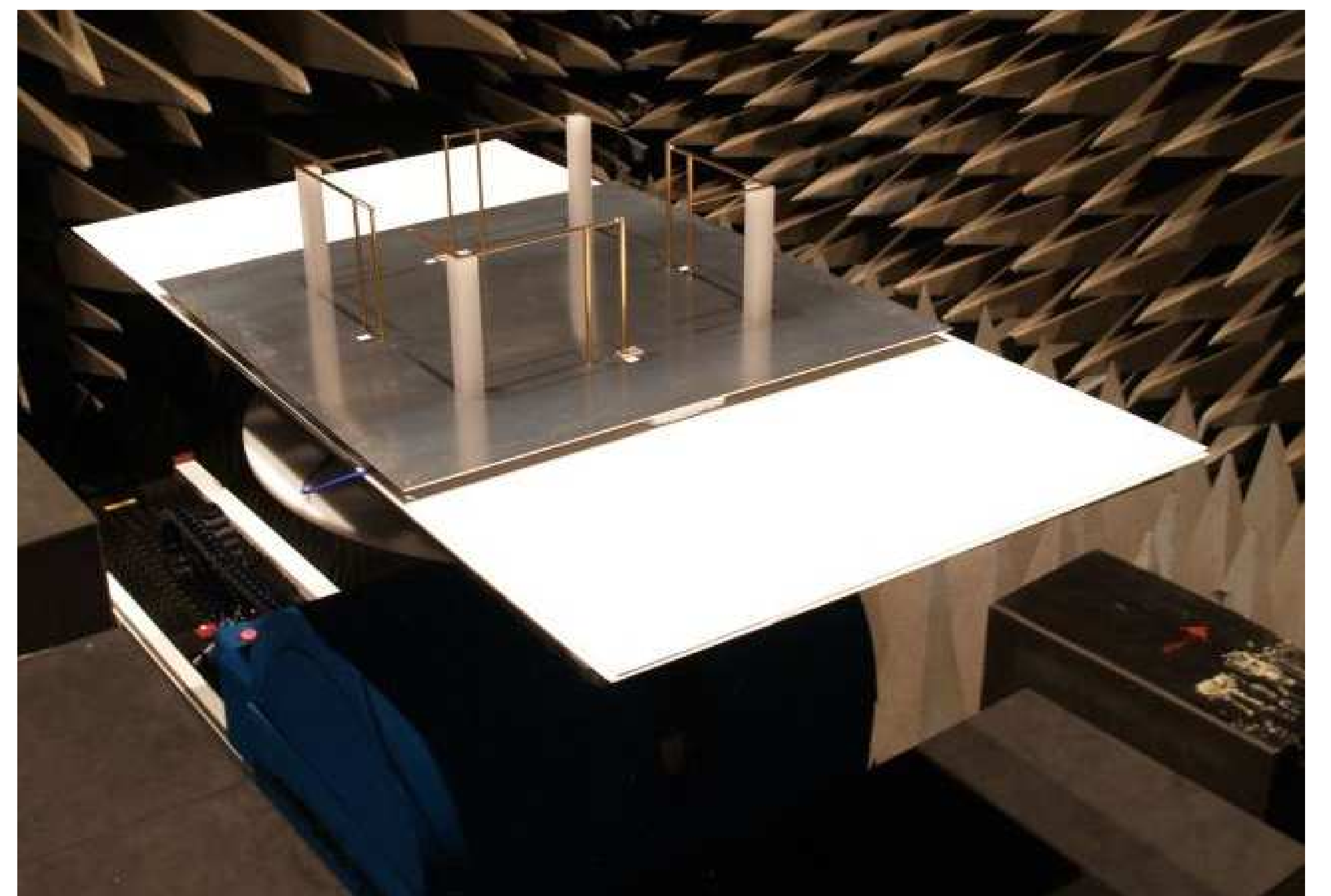
試作車載局アンテナ (セクタ指向性+4.5dBiを実現)
