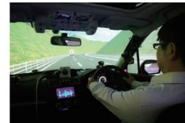
自動運転と手動運転の切り換えが可能な運転シミュレータ
