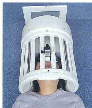
図2 強磁場の中でも高品質の音や画像を提示できるセラミック型ヘッドホンや、プロジェクタ式視覚刺激提示装置 提示刺激はコンピュータで制御されます。
