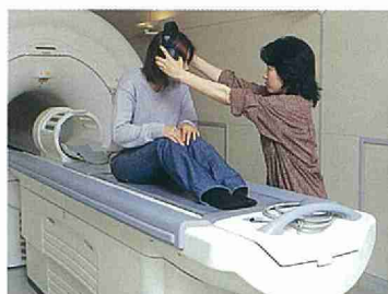
図2 強磁場の中でも高品質の音や画像を提示できるセラミック型ヘッドホンや、プロジェクタ式視覚刺激提示装置 提示刺激はコンピュータで制御されます。
