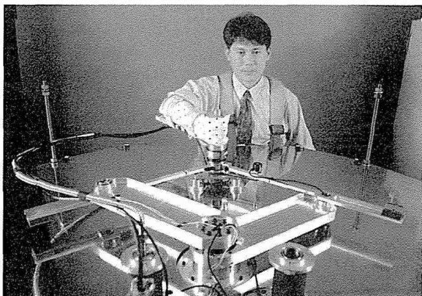
図4 運動中の腕のかたさを測る平行リンク磁気浮上型マニピュランダム
