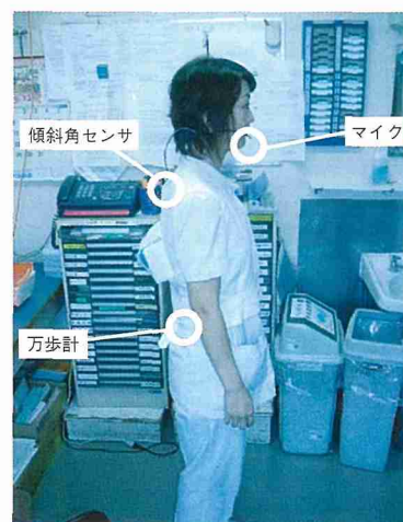
図2 E-ナイチンゲール・プロジェクトで使用する携帯型センサ・システム
