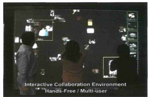
図1 SenseWeb：誰もが同時に、手のジェスチャと音声を用いてマルチメディア情報を簡単に操作、グループディスカッションを支援
